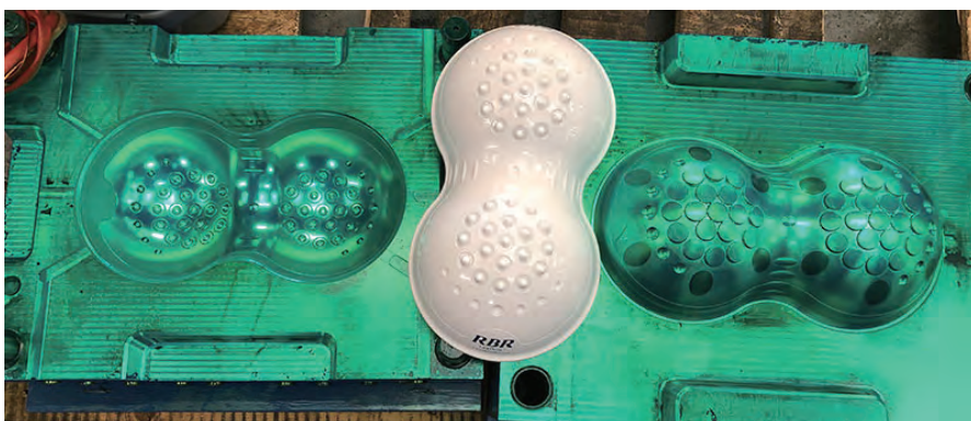
通过海克斯康生产制造软件 VISI Flow Lite 模拟注塑成型过程中的填充阶段，可以得到最优厚度
