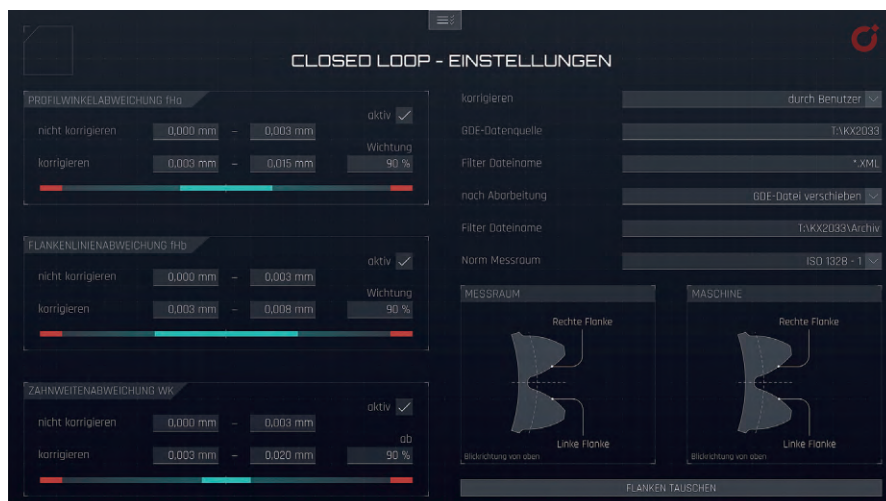
图2 通过“闭环”进行伴随生产的测量。通过深绿色区域可以识别到额定值漂移，在流程进行过程中就可以进行修正
