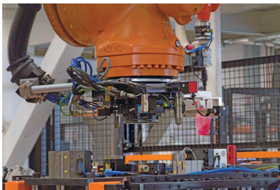
图 2 KR 1000Titan 机器人单元中使用的各种 Zimmer 抓手之一，总共 17 个
