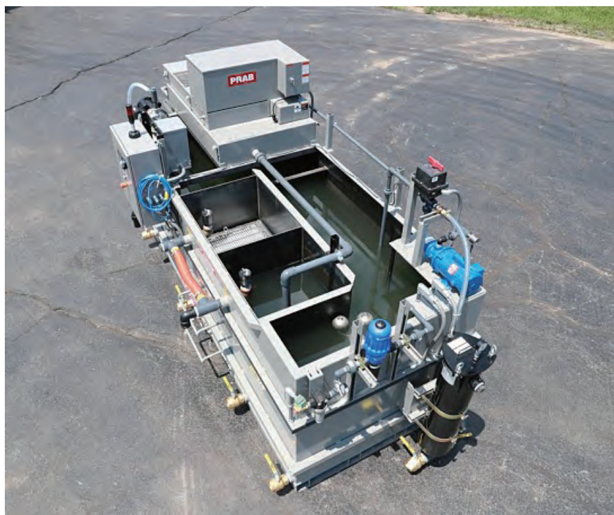
图3 PRAB 的监护系统位于 Koss Aerospace 公司的厂房外，准备安装。因为 PRAB 监护系统是“即插即用”，只需要连接水、空气和电力，两天之内就能在 Koss 航空航天设施中启动并运行
