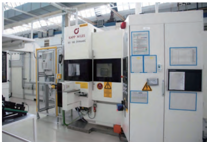
图 2 在车轮生产中的 KX 100 DYNAMIC
