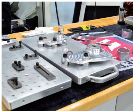
图2 Mitchell 先生认识到，Big Kaiser 的 Unilock 托盘可以让操作人员将零件预加载到机器外部的固定装置上，从而缩短安装时间
