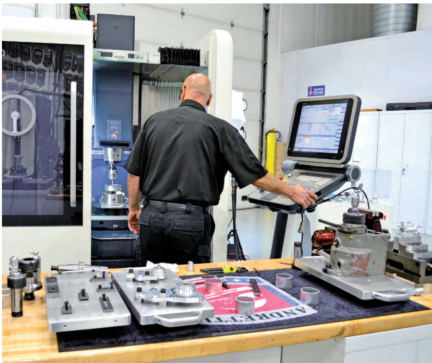
图 1 Charlie Mitchell 先生作为 Andretti Autosport 的机械师，在他的两台主要铣床中的一台旁工作。在他身后，Unilock 托盘已经准备就绪。对 Charlie Mitchell 先生来说，快速周转是至关重要的，且需要更快的安装时间
