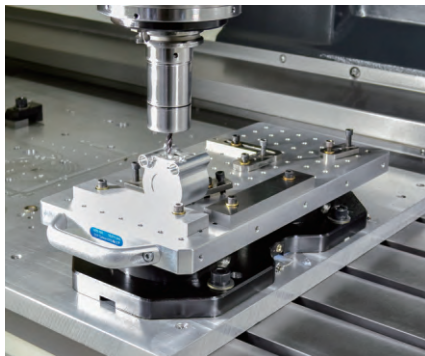
图3 Unilock 托盘使用网格孔，以便在需要时更换夹具。夹具系统使用弹簧压力或手动致动来夹紧这些固定位置的旋钮，以便快速卸载、加载和定位夹具。标准的旋钮可以从底部被夹紧并将其安装在盲定位孔中，也可以从夹具顶部被固定
