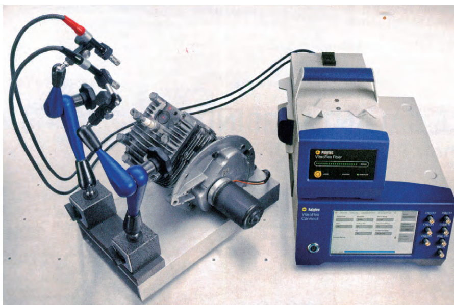
图1 有相对运动或者在不易接近的场地中适用的差分振动测量仪
