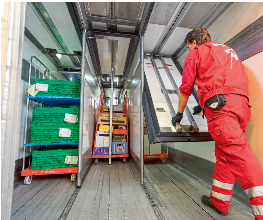
图 3 借助于冷藏车车厢内的不同温度区域和可变的冷藏区间，可以在一次供货时向用户供应不同冷藏温度要求的生鲜食品
