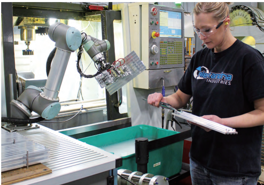
图 1 Alexandria 工业公司在第一次引入机器人负责机床工作时，遇到了不少问题。而现在，该公司已经拥有 20 多台机器人，包括协作机器人，简称“cobots”。协作机器人的引用，省去了围栏部分，提高了机器操作人员的工作安全性
