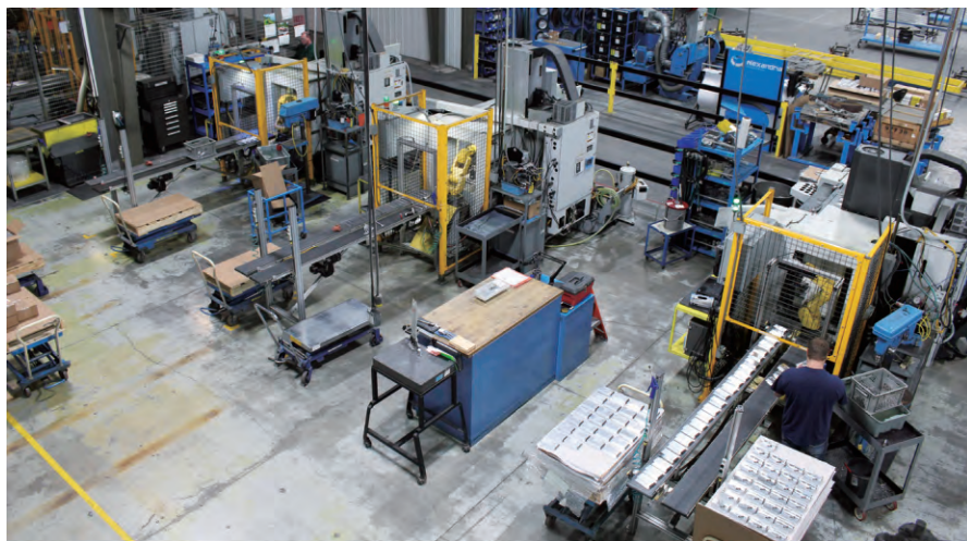
图2 图中是某些公司简化出示单元后新增且已开始发挥作用的加工单元。一个操作人员可同时负责3个单元
