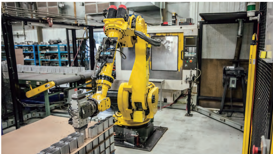
图 3 现在，Alexandria 工业公司的第一台机器人 Meet Rosie 已经退役。FANUC S-430iF 机器人所在单元有两套光幕分隔成两个安全区域。部件托盘装满后需切换至新的托盘时，操作人员进入单元，破坏外层的光幕。之后，单元继续运行（除非操作人员将里面那层光幕一并打开）。但是，机器人的工作并非是将加工后的部件放在托盘上，而是将其放在某个平台区域。切换托盘后，操作人员重置外层光幕，机器人之后将放在平台区域的部件移动到新的托盘中，继续正常运行
