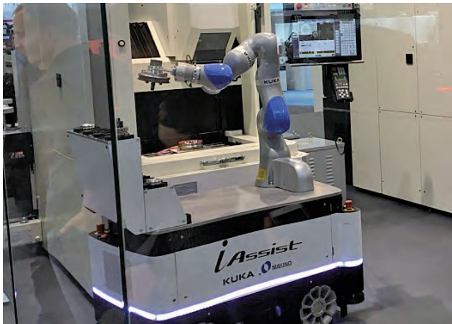
图2 自动导向车（AGVs）的精度和性能的提升使其成为协作机器人的有效平台。这个移动协作机器人是在 EMO 展会上所拍摄的
