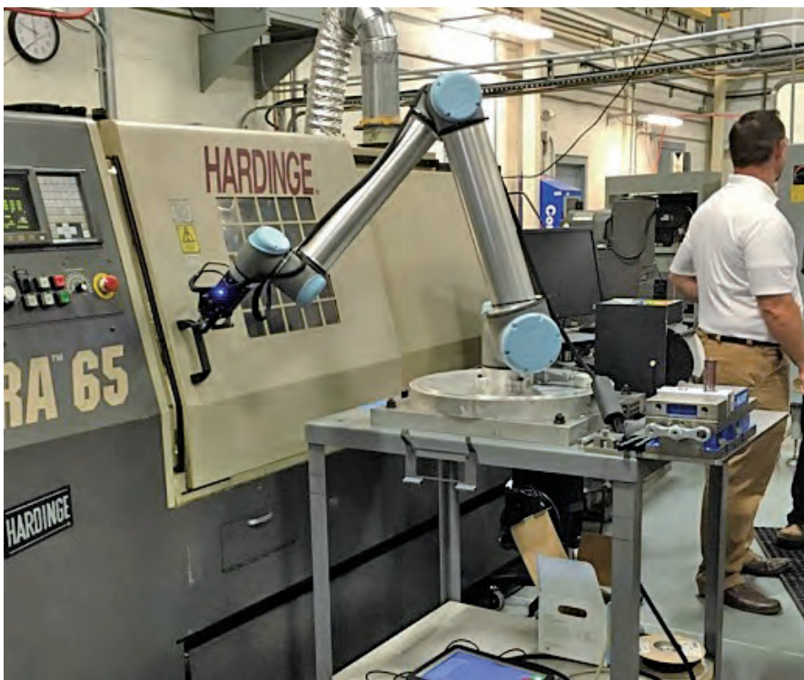
图 1 图片中的协作机器人不仅可以装卸机床，还可以关门并按下循环启动按钮
