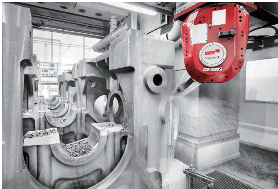
图 2 龙门式加工中心一次装夹即可完成对极重型工件的加工，从而大大减少了加工时间。曲轴箱也可以在其操作位置上加工
