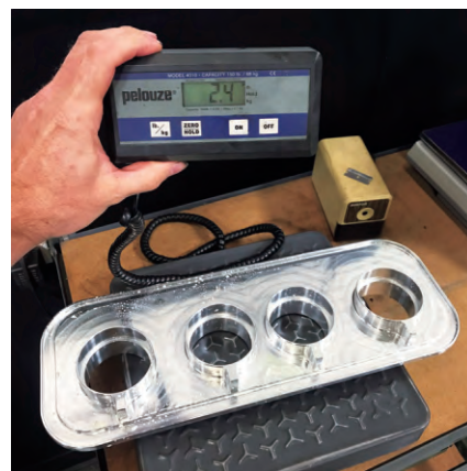
图 4 起初，这款适配器重 27 lb，采用的是铝材。经过机加工处理后，最终部件重 2.4 lb，尺寸为 19.25 in × 7.25 in × 1.95 in。底座厚 0.125 in，孔壁厚 3 in，厚 0.075 in
