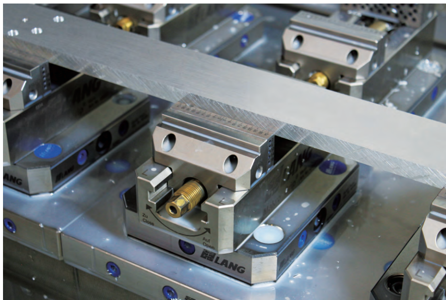
图 3 该车间自动化的第一步是引入了 Lang Technik 公司生产的零点夹持系统和 Makro-Grip 五轴虎钳。前者确保弓箭定位可重复性，后者只夹住部件的一小部分，从而确保能够从部件的五个方向顺利接触到部件。部件通过 20 t 冲压机形成底部槽口后，虎钳钳口部分的“牙齿”与槽口咬合。所以，即使只是抓住了部件的一小部分，这款装置也能够提供很高的夹持力
