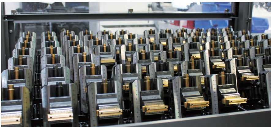
图 4 根据部件尺寸，自动化小车最多可以堆放 42 个虎钳。Lang 公司生产的 Robotrex 系统配备了 4 台小拖车，也就是说，最大储存能力可以达到 168 个虎钳
