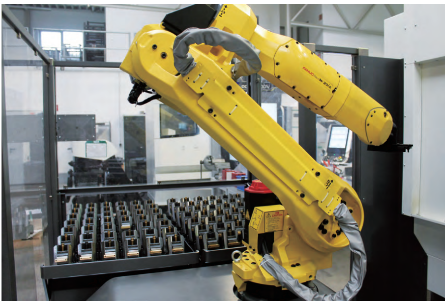
图 1 德国 Zelos Zerspanung 机加工车间采用了一款灵活的机床看管机器人系统，其特点在于夹住的不是实际的部件，而是固定部件的虎钳。通过这种方式，只需要一个抓手。切换至新的加工内容时，也无需重新编程
