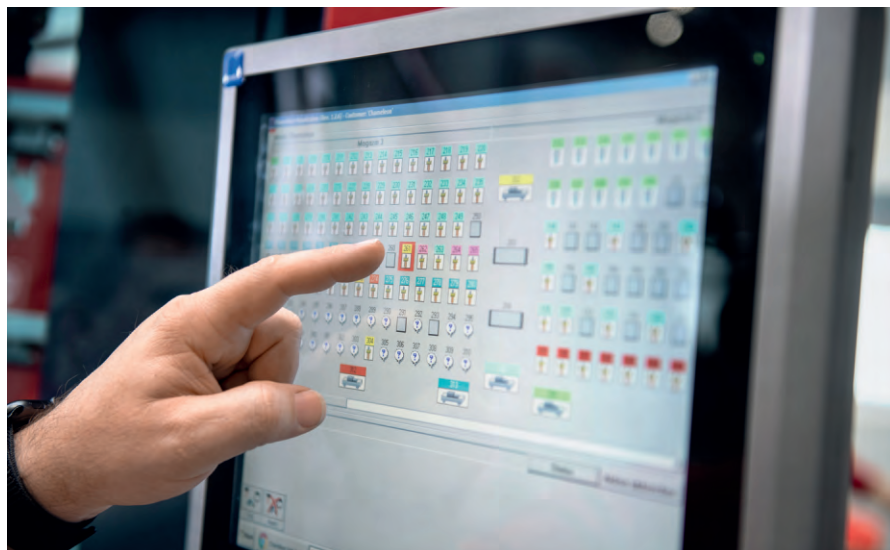
图 3 蔡司测量系统的监视器告知操作人员工件是否满足公差要求
