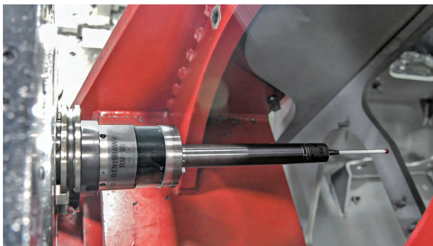
图 2 在考察了多种机床测头技术之后，Tigercat 公司最终选择了雷尼绍高精度触发式无线电测头以及基于计算机编程的测头测量软件
