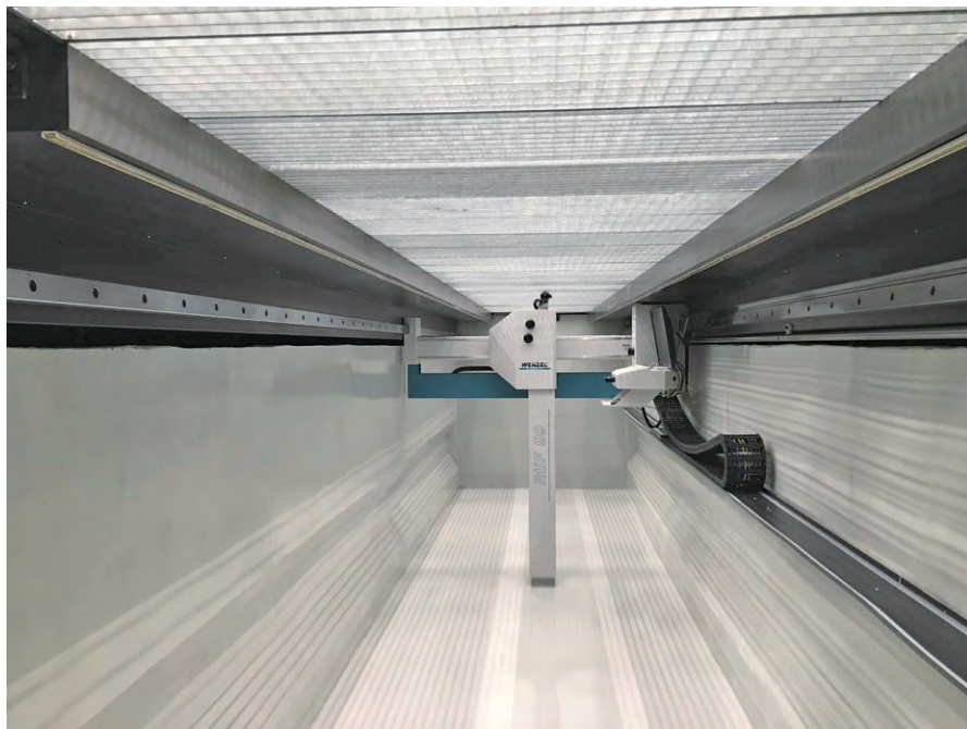
图2 地底式悬臂测量机 RUF
