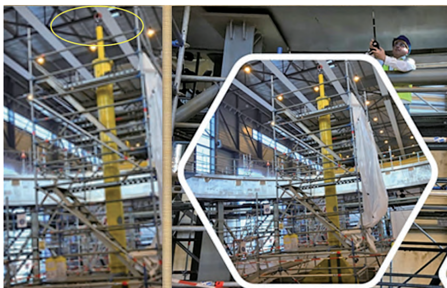
图 3 使用 API Radian 激光跟踪仪配合 vProbe 隐藏点智能测头测量 ITER 项目低温恒温器（跟踪仪安装在 29 m 高支架上）
