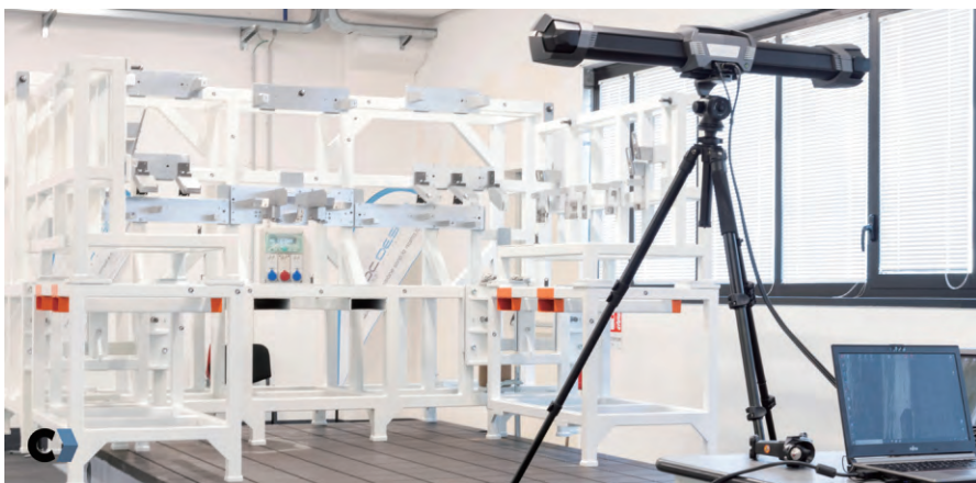
图 1 新设备还用于测量大型设备，这是一项使用手工测量设备几乎无法完成的任务
