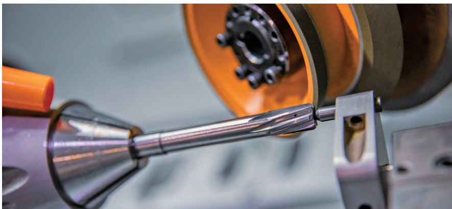
ANCA 磨床再加上标准 ToolRoom 软件可以生产出非常精确的铰刀
