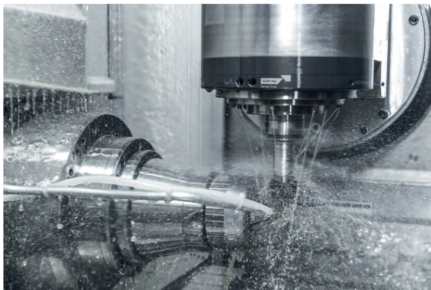
图2在宝美 s191 上加工由两个零件组成的骨科器械大大减少了生产环节
