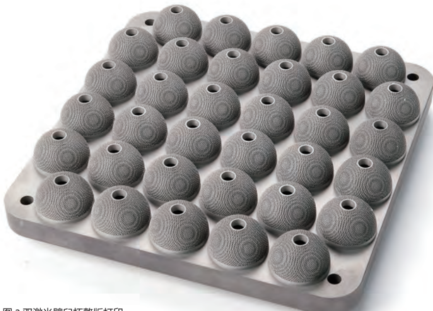
图 2 双激光髌臼杯整版打印
