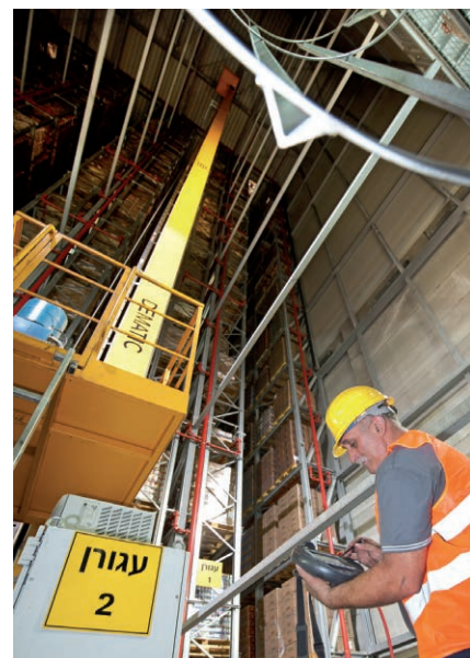
图3 Osem 公司食品配送中心的无人操作的货物运输系统装备有 1600 个托盘放置位的货架通道
