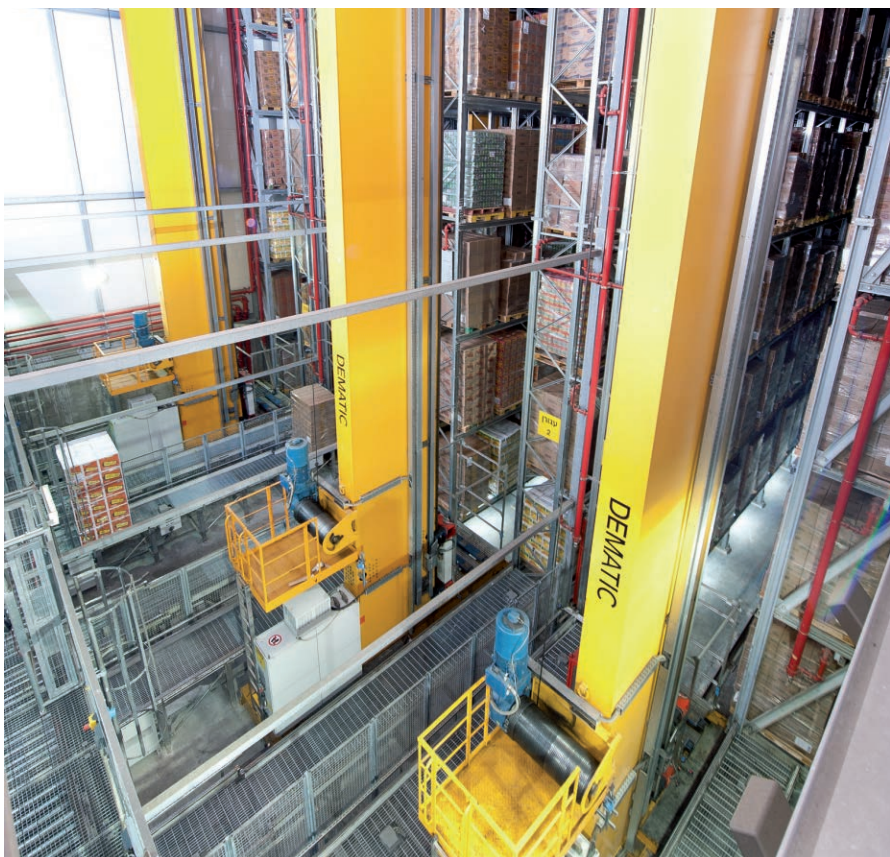
图 1 Dematic 向以色列的食品生产厂家 Osem 公司提供了一台 4 通道、高 40 m、长 180 m 的托盘式高货架设备
