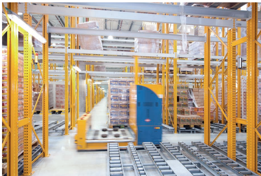
图2 Osem 公司的仓库使用自动化、无人操作的运输系统 (FTS) 出货, 根据双方合同, 该运输系统装备有两条重力 (皮带) 输送装置
