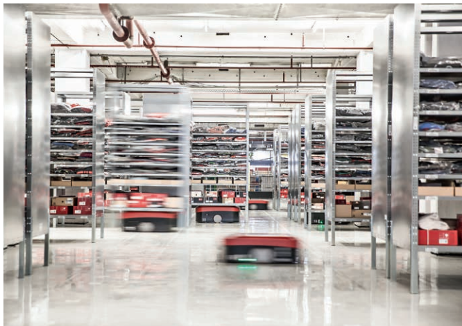
图2 移动运输车的最大举升重量为 600 kg，装有胶体铅硅蓄电池
