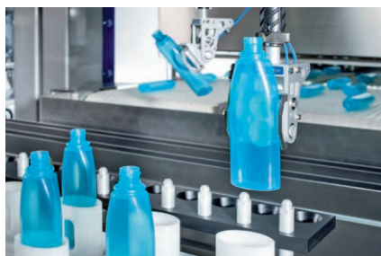
图 2 由一扫描仪检测抵达的 PET 化妆品瓶。TLM-F4 机器人抓起化妆品瓶并将其放入规格件内
