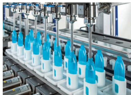
图 4 在液体灌装过程中，液体灌装针可根据所灌装的产品液体进行或高或低的灌装高度调整
