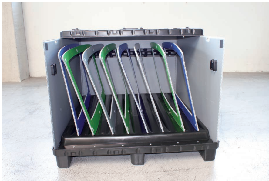
图 2 巨大而敏感的汽车后窗玻璃框的搬运轻而易举：推开箱盖，去掉固定的正面板，从中取出产品
