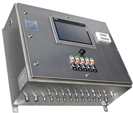
图2 一个带有触摸式人机界面和各种输入装置包括可编程控制器在内的用于防爆1区的开关/控制柜，其防护外壳内压调节系统对内部安装的组件起到保护作用
