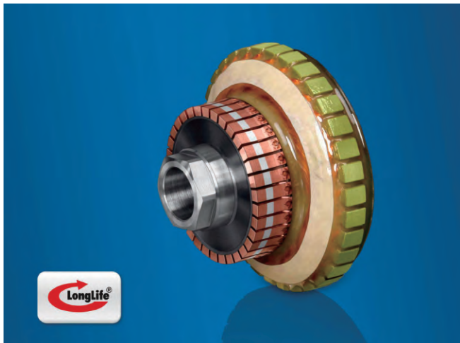
图2 堡盟测速发电机采用 LongLife® 专利换向环，其表面嵌入了银轨，可以满足苛刻的要求
