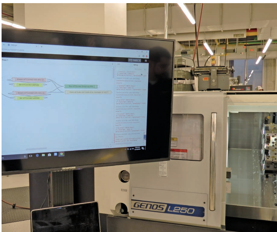
图 1 Georgia Tech 公司使用亚马逊网路服务系统 (AWS) 的物联网平台收集并分析一台带锯机以及图中所示计算书数控机床的数据。AWS 与其他服务搭配使用，可以在发现错误使用情况后或在设备报告错误信息后，向教研人员发出通知
