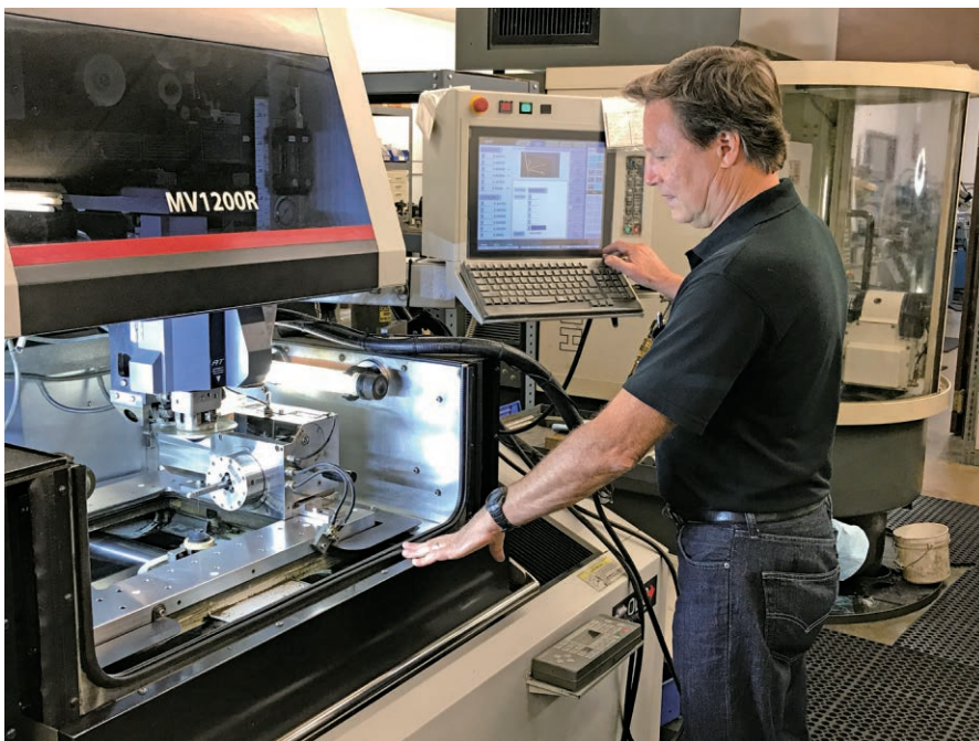
图 1 图中，德克萨斯州达拉斯附近一家 MCC 工具制造厂的老板 Marcus Alexander 正在运行一台使用 MMK Matsumoto 轴的三菱 MVR1200-R 电线 EDM 机。Esprit 模拟软件大大提升了该车间的操作速度，节省了更多时间，同时也降低了过程中部件的报废率
