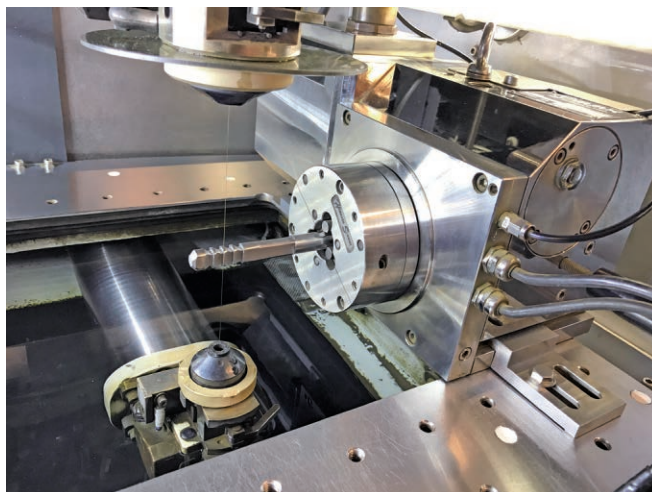
图3 MCC过去的做法是在铣床上进行粗加工磨削，然后放在三菱EDM机的B轴上进行机加工。每次MCC Tooling车间都可以在不移动工具的情况下，用铲子将工具翘起来，同时将一个不同的半径添加到每个齿轮中。这也只是Esprit软件给MCC Tooling带来的优势之一
