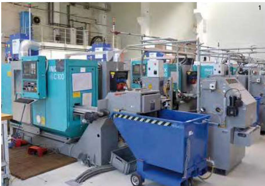
图 1 "Indexhausen": RORA 公司 总经理 Markus Kreisle 关于其所加工产品的说法证实了埃斯林根合作伙伴的机床和技术支持能力的价值——5 台并排的 C100 自动车床用于支柱生产
