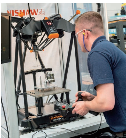
Equator 比对仪使用已编程序检测航空航天设备零件
