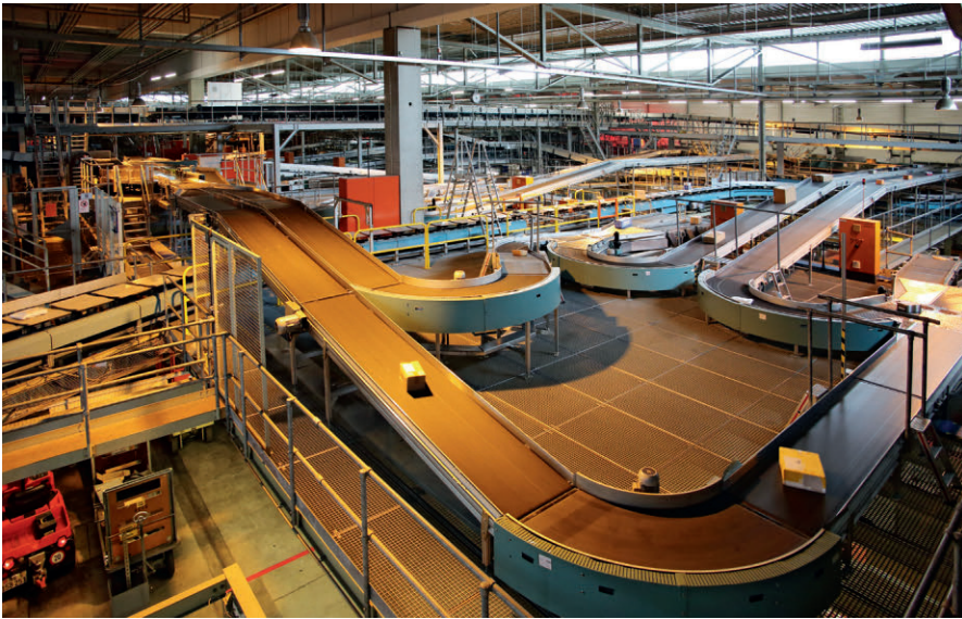
图 1 位于 Frauenfeld 的包裹配送中心：针对 6 m 高的全新交叉带式分拣机，安装了 2100 m 长的输送机
