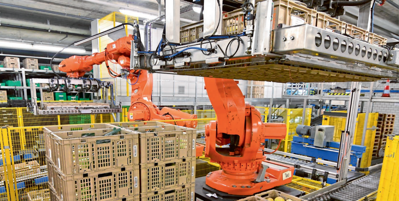
在多穿梭车仓库中存储物资时使用的 IFCO 周转箱和标准的 Migros 周转箱的自动分拣设备
