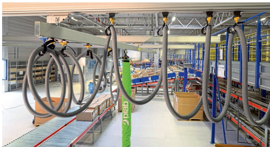
图2 凭借 Piab 公司专门为 DHL 设计的导轨系统使 piLIFT SMART 真空起吊设备可以灵活的达到物流大厅的各个托盘位置，而且绝不会妨碍地面运输车辆的通行
