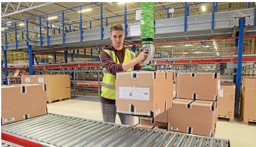
图 1 汉堡附近 DHL Solutions 物流中心新库区中使用的 piLIFT SMART 真空升降机能够将人工拣选仓库中的包装纸箱重新送回到自动拣选系统中去
