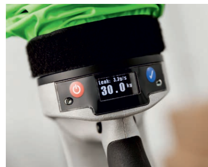
图4 piLIFT SMART 真空升降装置可以在升降过程中完成计数、称重和真空度检验等任务工频繁的弯腰、起身，减轻了他们的劳动强度纸箱重新送回到自动拣选系统中去
