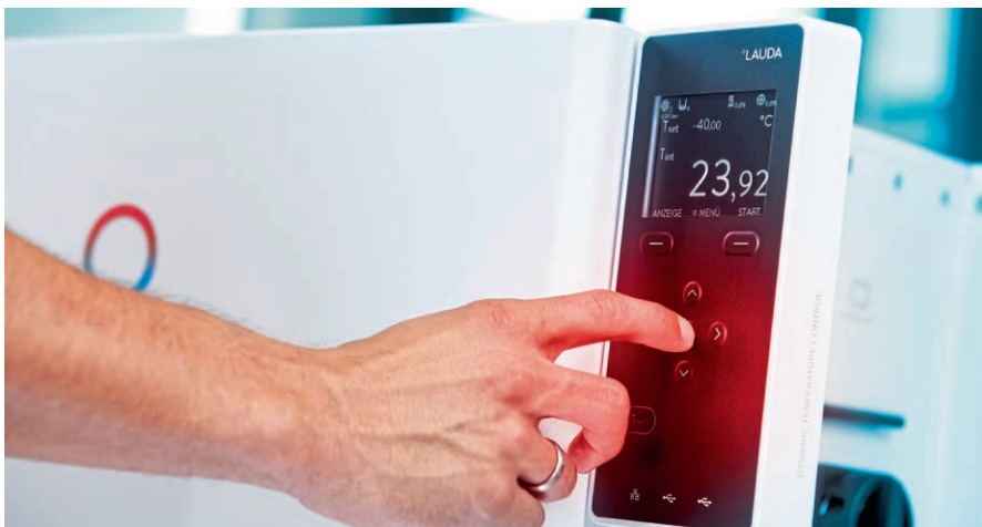
图 1 Lauda 公司研发生产的自动调温器是按照流量原理工作的、并带有低温油覆盖功能, 因此可以在较宽的温度范围内控制温度介质
