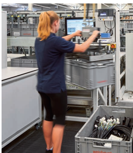
图 1 透明的对话设备：透明的工作现场对话设备可以指导员工完成所有的物流任务。集成在内的电子秤确保了高质量、无差错的物资拣选配货
