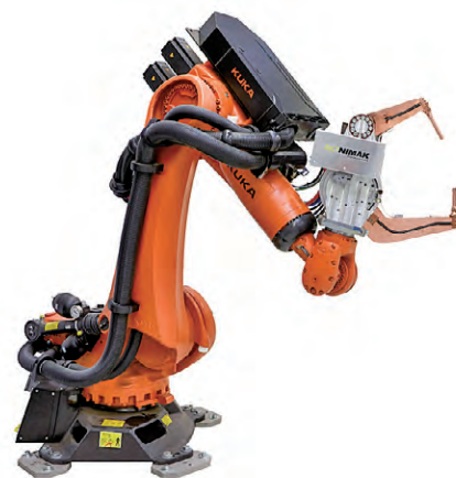
图3 galaxy®GUN 的首个产品原型集成在一个实验机器人中
