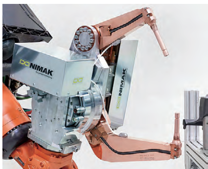
图2全新的 galaxy®GUN 则源自一种截然不同的设计理念，该理念将基础焊枪体、Galaxie® 传动系统和焊枪臂均集成在一个结构更加紧凑且重量比以往轻 20% 左右的模块中
