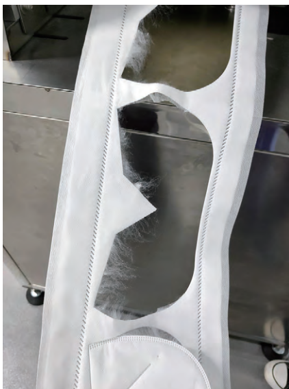
图 1 熔切不断拉丝效果图（左）与熔切无毛边合格图（右）
