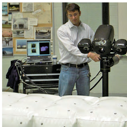
图 2 采用照相式测量技术在艇尾的表面上设置标志点，然后进行完整的扫描
