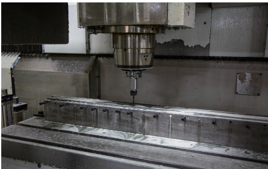
Bertsche XiMill 加工中心主要负责针杆钻孔。将待钻孔的针杆固定在工作台和机床上后，利用转速达到 15 000 r/min 的 HSK 63 主轴进行凹坑铣削，在铁制和钛制长针杆上形成孔眼。该机器行程长，可以加工最长 210 in 的针杆
