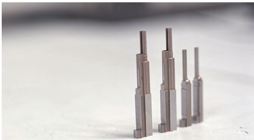
图4 使用 Cimatron 设计和制造的高精度模具镶件
