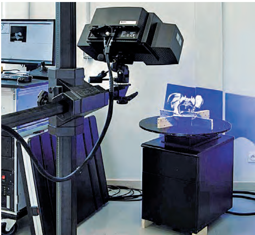
图 1 用 GOM ROT640 转台结合 GOM 扫描仪实现半自动化测量
