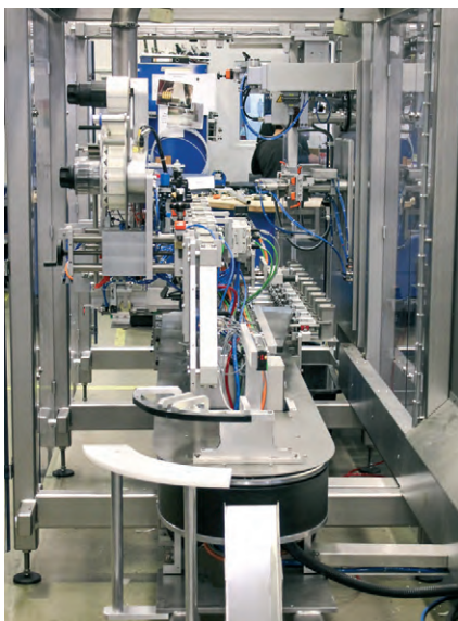
图 1 Wolf 公司通过基于贝加莱 SuperTrak 的解耦输送解决方案开发了适合更高性能范围的封口机
