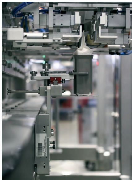
图 2 封口机的输送系统将每个袋子单独输送到加工工位
