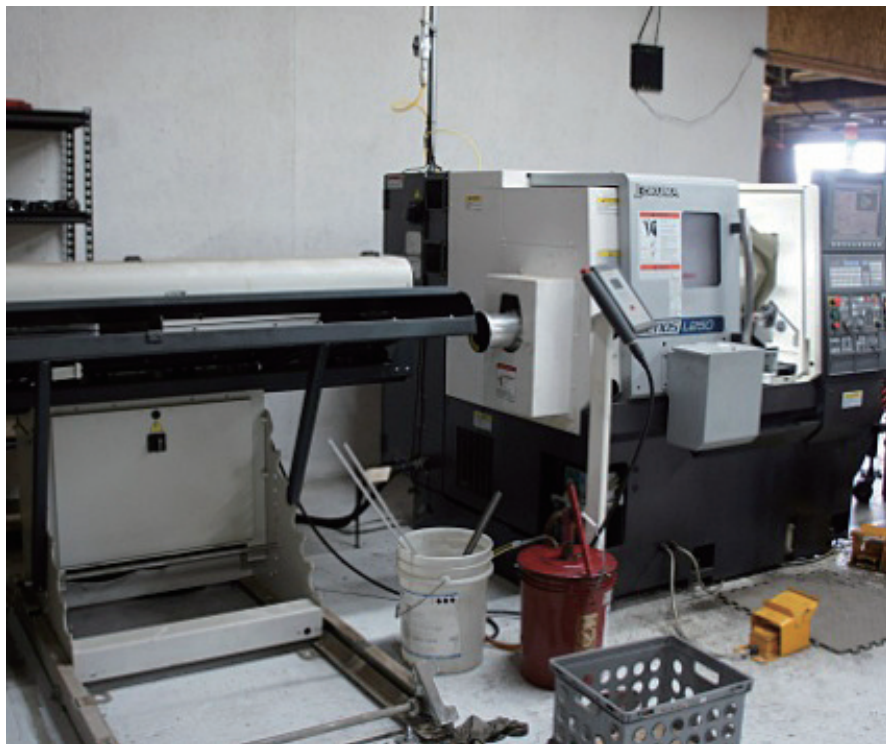
图 2 变量管理器应用程序特别适用于棒材送料车削加工中心。温策尔先生和他手下的操作人员无需修改部件程序便可快速更换部件计数变量
