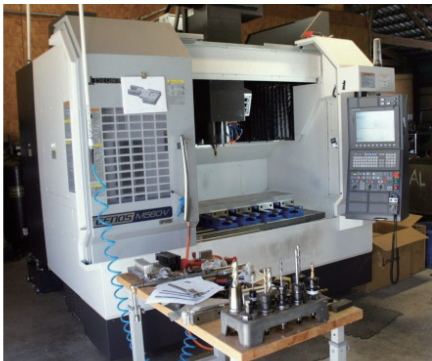
图 4 Renishaw 设置和检查应用程序能够自主生成报告，加快车间铣床（例如图中所示的三轴 VMC）的探测过程。用户通过菜单选择探测周期，并填写输入栏，生成该探测周期的机器代码
