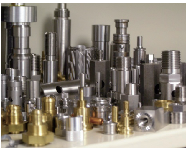
图 1 图中所示的小部件（超高体量的液压自动组件）在测量和检验时相当麻烦。需要对 20 多个特征进行验证。为此，公司专门从 Alpha Grainger 公司引入了全新的数字视觉系统
