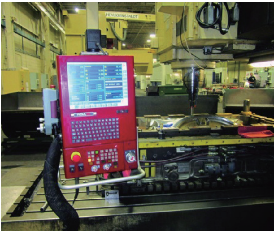
Fidia C40 计算机数控视觉系统通过多处理器构架管理用户界面、轴承和工具路径控
