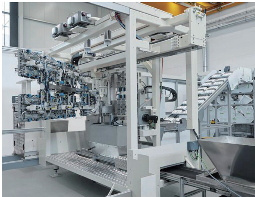
图 3 在固定的有限安装空间内，只能选择对新电机 / 齿轮箱单元进行机械式集成，Galaxie® D 产品结构紧凑的优势再次得到彰显
