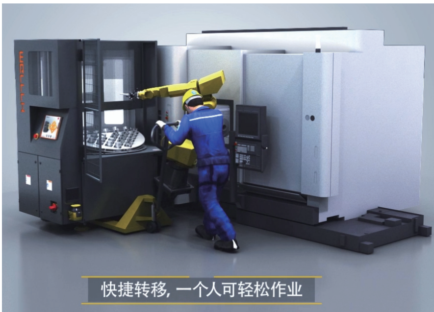
图 1 3S 柔性智能工作站，专为中小批量生产而定制，具有经济高效、操作简易、安全可靠、设置快捷、自由切换及占地面积小等优点
