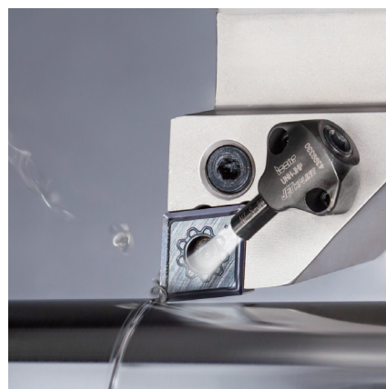
图 2 可确保切削流畅轻快，断屑效果显著。经过设计的刀口几何形状所表现出的优异加工性能，是切屑流建模的直接结果
