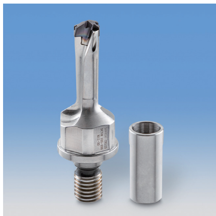
图 3 通过将带有 FLEXFIT 螺纹接口的规格多样的接柄与同样规格多样的圆柱柄相配对，可有效对钻头实施精确匹配，最大限度地缩短刀具悬伸
