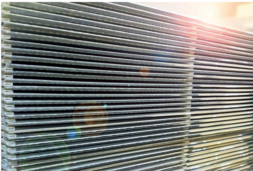
图 1 由膜和波纹铝堆叠的压层用于生产住宅和商业建筑通风中回收能量的热交换器
